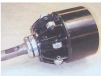
Rollenkalibriertechnik formt das Altrohr aus und reduziert Reibung.
