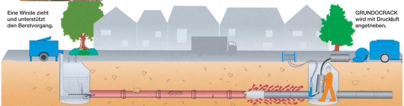
**Besonders geeignet zur Erneuerung von Altleitungen aus Steinzeug, Beton, Grauguss und Asbestzement.**
